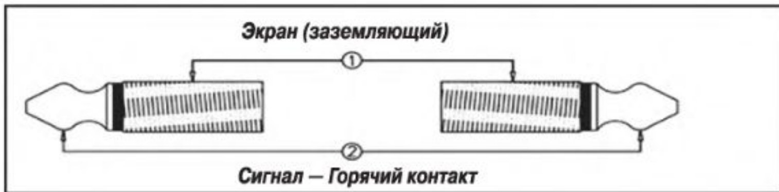
Рис. 2. Схема распайки штатного соединительного кабеля для линейного моносигнала.
